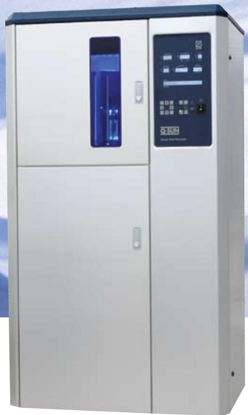
Q-Sun B02 Enceinte d'essai de photostabilité au Xénon
